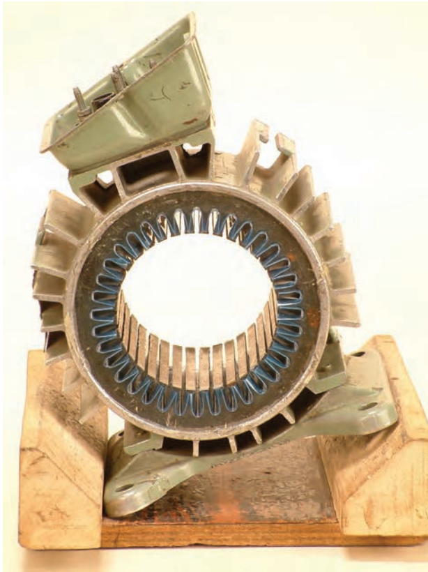
شکل ۲۹-۲-ب - انتخاب شیار شروع سیم بندی
