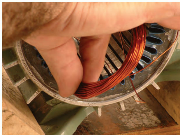
شکل ۲-۱۵- قراردادن بازوی شماره یک در شیار شماره ۱
