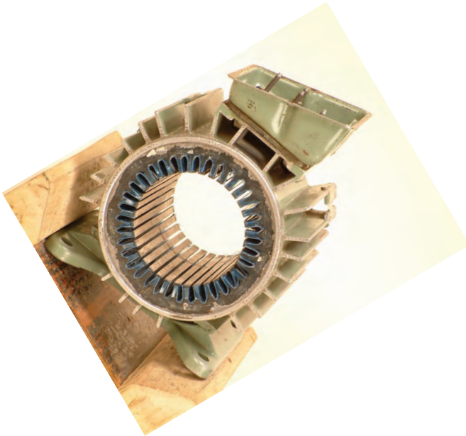
شکل ۱۲-۲- پوسته موتور سه فاز ۳۶ شیار
